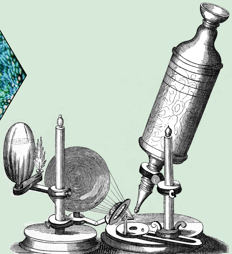
Schematische Darstellung des Mikroskops von Robert Hooke (ca. 1664)
