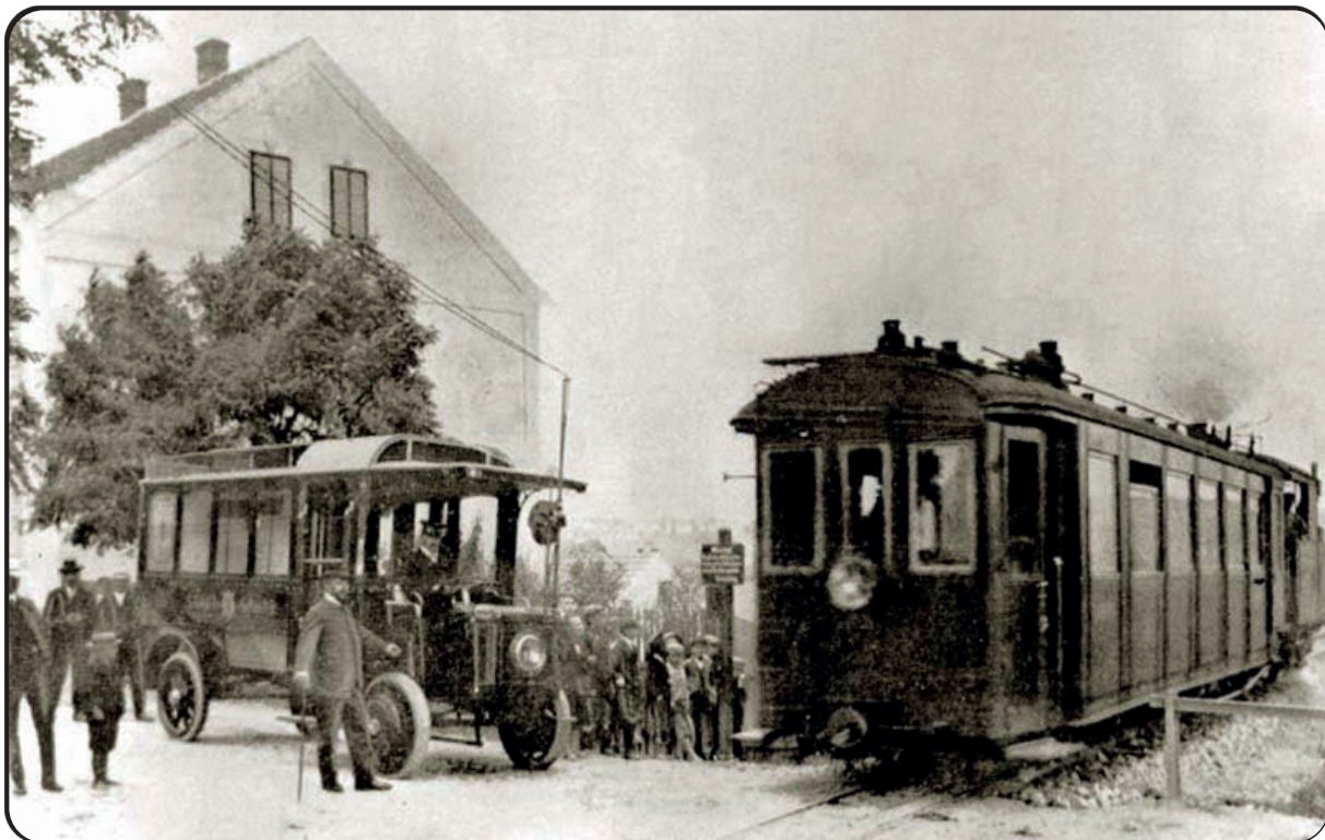
1907 Gmünd, Niederösterreich (damals mit Linksverkehr!): Ein elektrischer Omnibus mit Oberleitung (links) begegnet einem mit Dampf angetriebenen Eisenbahntriebwagen.
